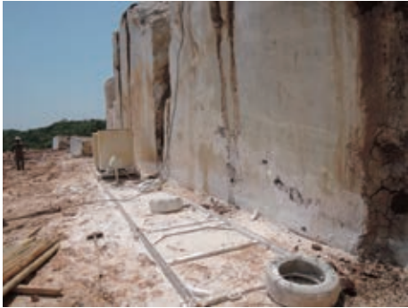
用金剛石繩鋸在大理石岩體水平面上切割。
